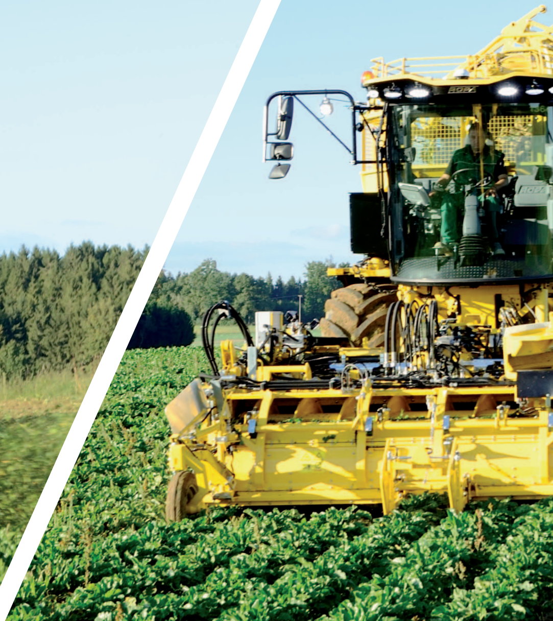
ROPA Allround cepový ořezávač Integrální ukládání chrástu
